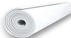
Les MatSA flexibles sont utilisés pour réaliser des isolations de haute performance dans des volumes restreints, ou pour des températures élevées. Les mini-billes de silice amorphe sont combinées à des fibres de verre afin de constituer les MatSA de différentes épaisseurs.
