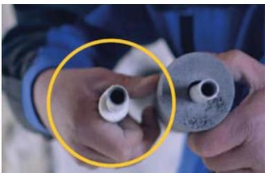
Pour des tuyauteries de haute performance:  $U_i = 0,11 \text{ W/mK}$
